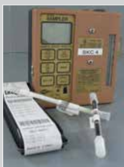
Prise d'échantillon par tubes de prélèvement
