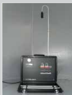
Mesures d'amiante suivant VDI 3492
